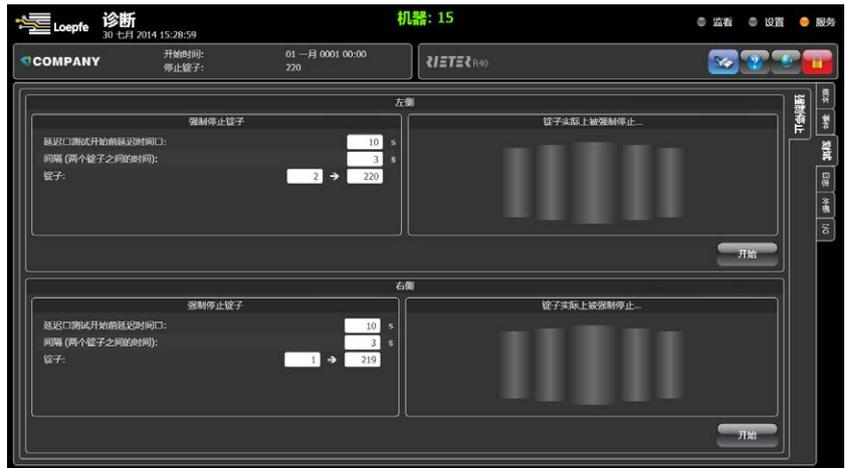
测试用于检查 LZE-V、SE和检查头之间的通信以及SE和机台分区电子设备之间的接口连接通信。
