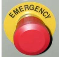
按下织机的紧急关机按钮将中断织机和WeftMaster CUT-iT的运行
