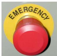
Das Drücken der Not-Aus-Taste der Webmaschine unterbricht den Betrieb der Webmaschine und des WeftMaster CUT-iT
